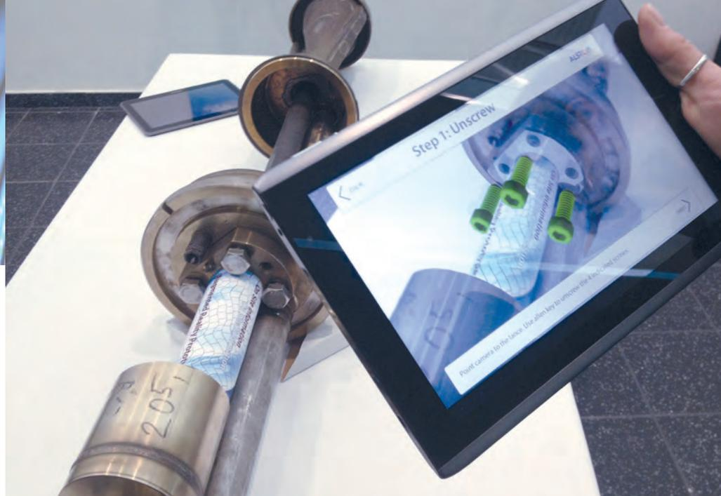
Illustration 1: Preuve de concept d'une application de services en réalité augmentée pour les travaux de révision; coopération de projet de l'Alstom Future Technology Program avec la FHNW, Institut des technologies 4D, 2014 (reproduction avec l'aimable autorisation d'Alstom Switzerland Ltd)
