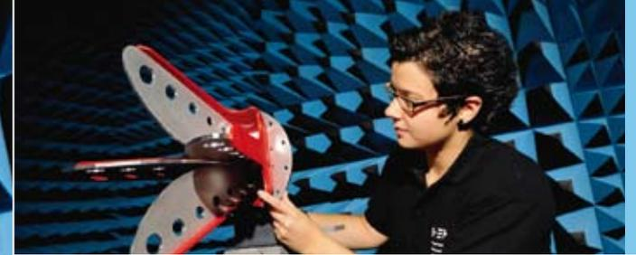
▲ Die kommerzielle Testantenne wird nur in der Messkammer gebraucht und muss genau ausgerichtet werden.
