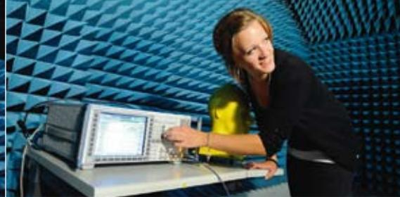
▲ Alexandra stellt das Handytestgerät so ein, dass die Strahlung in allen Handy-Betriebsarten separat ausgemessen werden kann.
