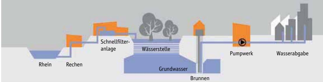
Das Rheinwasser wird über mehrere Stationen aufbereitet, bis es in den Haushalten als sauberes Trinkwasser aus den Hähnen fliesst.
