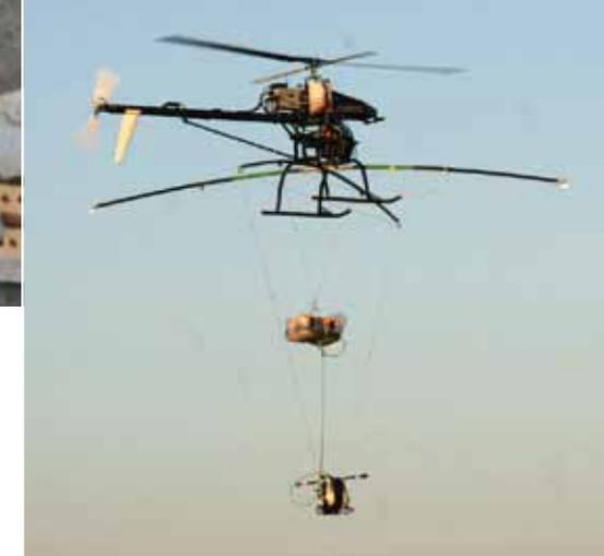
Von oben sieht man mehr: Dieser unbemannte Helikopter wird für unterschiedliche Messungen eingesetzt.
