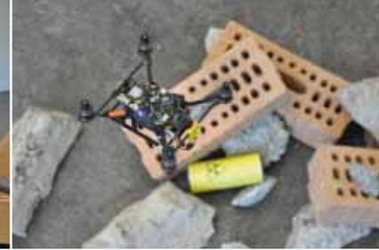
Teamarbeit bei Rettungsaktionen: Der fahrende Roboter kann Lasten wegtransportieren und so sich den Weg freiräumen, der fliegende Roboter liefert die Übersicht.
