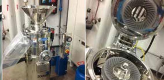
Empa-Forschende stellen zum Beispiel aus Altpapier eine Gel-artige Nanozellulose her und suchen nach möglichen Anwendungen. Für die Produktion der Nanozellulose nutzen die Forschenden unter anderem dieses Aufschlussgerät.
