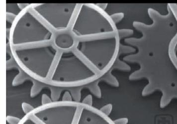
Mikromaschine: Massstab 1/1'000'000 Meter
