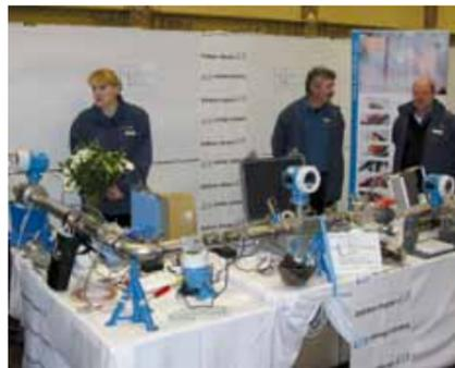
Eine spezielle Messmethode ermöglicht es sogar, den Durchfluss in einer Leitung von aussen zu messen – beispielsweise bei Wasserleitungen. Die Teilnehmer erhalten in diesem Modul Gelegenheit, selber ein solches Messgerät zu installieren und anschliessend den Durchfluss zu messen.
