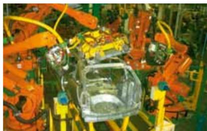
Die Automation funktioniert ähnlich wie das Nervensystem. Wie im Körper messen zahlreiche Fühler die Umgebung: Temperatur, Geschwindigkeit, chemische Zusammensetzung, Abnutzung der Werkzeuge, etc. Datenleitungen übertragen diese Messwerte zu Steuerungscomputern. Diese Computer bearbeiten die Messwerte, geben Befehle an «Muskeln», zum Beispiel Motoren oder Schalter, und zeigen den Zustand der Anlage dem Bedienungspersonal an.
