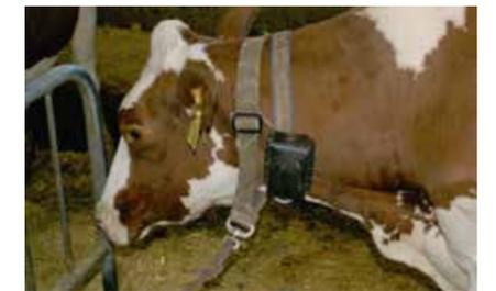
Das System «Anemon» löst das Problem der Milchbauern: Das Gerät, das auf einem Sensor basiert, misst die Körpertemperatur und Aktivität der Kuh. Wenn diese brünstig ist, schickt es ein SMS.
